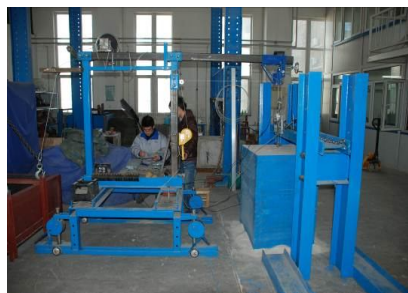
图 5 扩体锚杆模型试验照片
